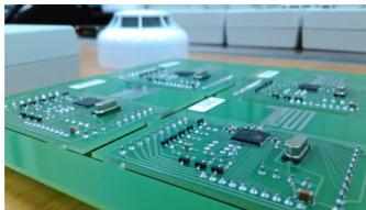
Основой аппаратной части каждого узла в сети является ультрасовременный AVR микроконтроллеры фирмы Atmel – ATMega128RFA1 (класса SoC), уже содержащий в себе сетевые возможности, удовлетворяющий требованиям экономичного энергопотребления, универсальности, надежности работы и доступной цены.
