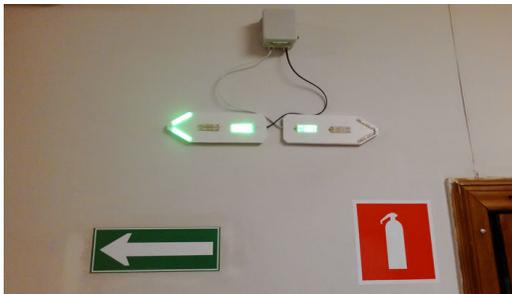
Рисунок 2.1 — Опытный экземпляр сенсорного узла экспериментальной системы управления эвакуацией и светодиодные указатели направлений движения людей.
