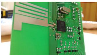
В микроконтроллер ATMega128RFA1 встроен приемопередатчик, работающий на частоте 2,4 ГГц, обеспечивающий передачу цифровых данных на расстоянии порядка 50 метров. Геометрия антенны, обеспечивающей приемлемый уровень сигнала, реализована в виде разводки на плате.
