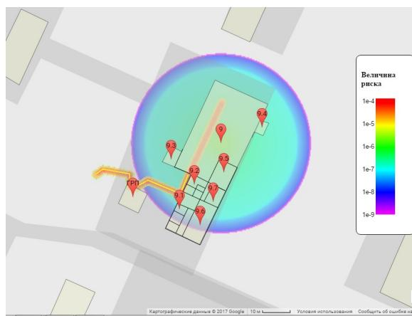
Рисунок 3 — Пример нанесения слоя потенциального риска на топооснову
