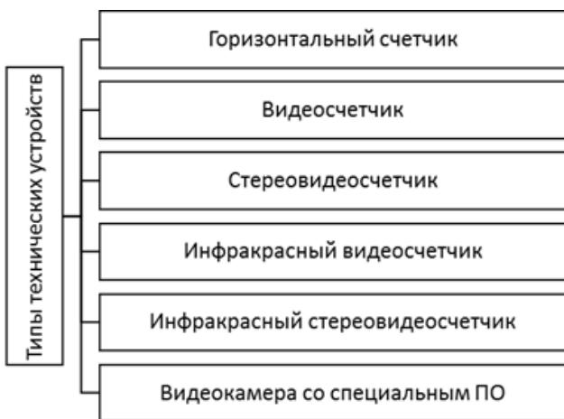
Рисунок 1 — Типы технических устройств, используемых для подсчета количества людей в здании.
