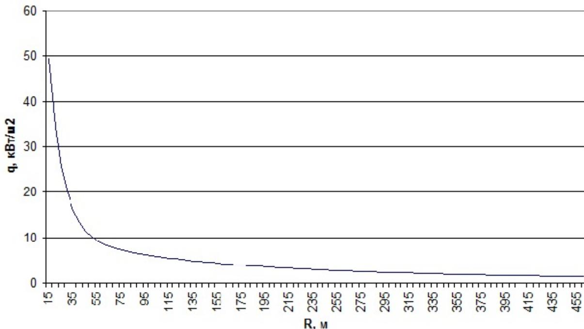
**Рис. 1.** Зависимость интенсивности теплового излучения,  $q$  от расстояния,  $R$ . Зависимость вероятности различной степени поражения людей тепловым излучением от расстояния определяется формулами приведенными в работе [4] и подразделяются на поражения: с летальным исходом, III степени, II степени, I степени и болевой порог. Примеры и сравнение приведена в статье "Оценка воздействия опасных факторов взрыва и пожара на людей" [5].
