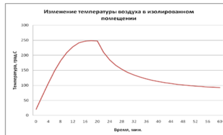
Рис. 3. Зависимость средней температуры воздуха от времени, полученная с помощью зонной модели.
