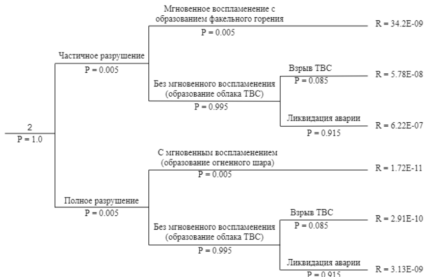
Рисунок 3 — Фрагмент дерева событий для аварии на газопроводе (в помещении АГРС)
