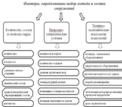
**Рис.2.** Факторы, определяющие выбор метода и состав сооружений
